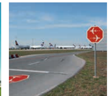
STOPP bei Luftfahrzeugrollverkehr, wenn sich ein kreuzendes oder parallel näherndes Luftfahrzeug auf circa 150 Meter nähert beziehungsweise im gleichen Abstand den Bereich verlassen hat.
