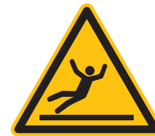
Warnung vor Rutschgefahr
