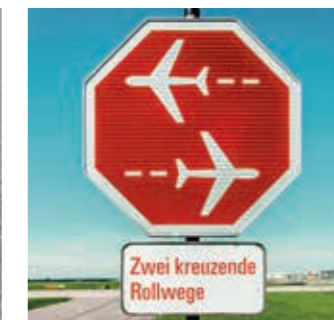
STOPP bei Luftfahrzeugrollverkehr, wenn sich ein kreuzendes oder parallel näherndes Luftfahrzeug auf circa 150 Meter nähert beziehungsweise im gleichen Abstand den Bereich verlassen hat.
