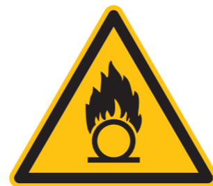
Warnung vor brandfördernden Stoffen
