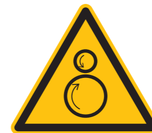
Warnung vor Einzugsgefahr
