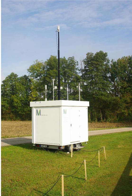
Abbildung 10. Außenansicht der mobilen Luftgütemessstation in Fraunberg.
