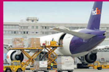
Über spezielle Hublifter und Rollen werden die Container ins Innere dieser Boeing 777F verladen.
