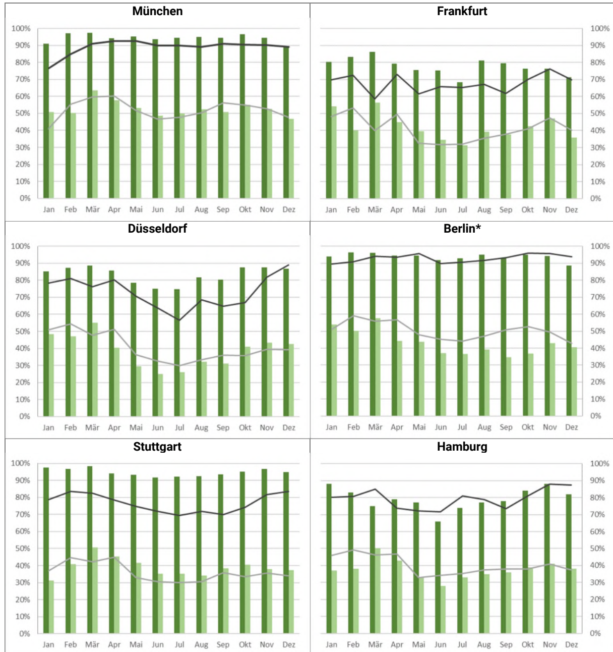
Abb. 11: Anteil der IFR-Abflüge 2022 (grün) und 2019 (grau), bei denen letzte TSAT = TOBT. Unreguliert dunkler gefärbt, reguliert heller.
