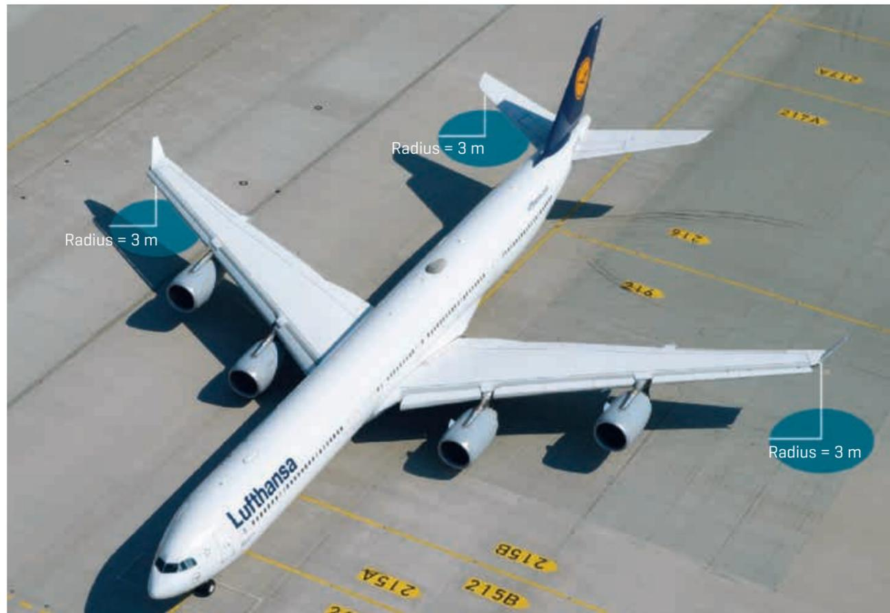
Bei Luftfahrzeugen mit Trimmtank im Höhenruder [zum Beispiel Airbus A330, A340, A380 oder Boeing 747] gibt es eine zusätzliche Tankentlüftung am rechten Höhenruder.
