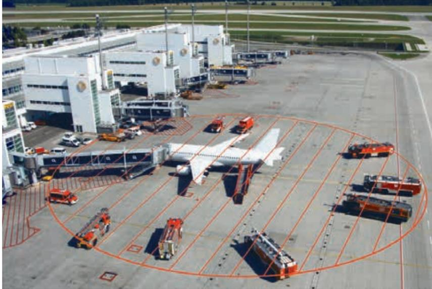
Während eines Feuerwehr- oder Rettungseinsatzes darf die Einsatzaufstellung nicht betreten oder befahren werden [rot schraffierter Bereich].
